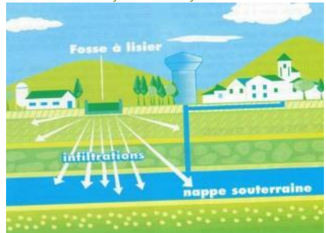
Figure 27. Contamination des eaux souterraines par une fosse à lisier fissurée
